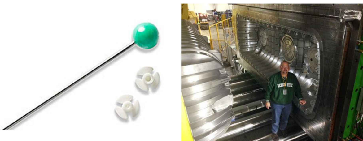
4.13. ábra Példák a fröccsöntéssel legyártható legkisebb (a) és legnagyobb (b) méretű alkatrészekre [16, 17]
