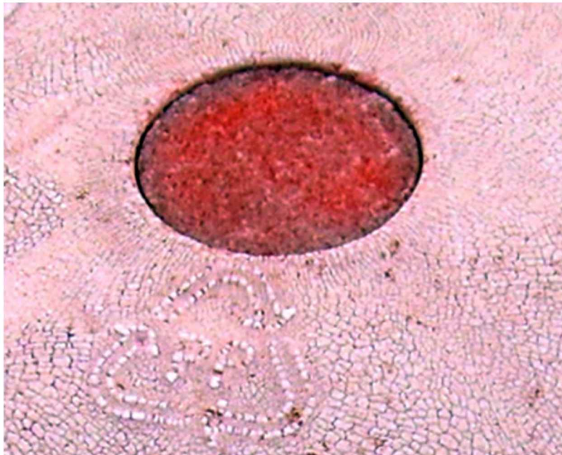
2.17. ábra Játszótéri mászóka faoszlopának eredetileg piros színű polipropilénből készült zárófedelének részlete
